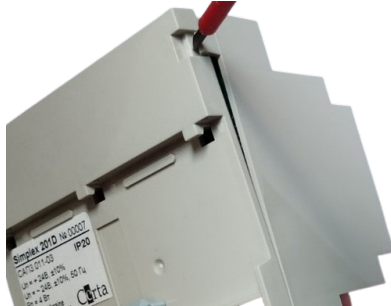
Рисунок 7 -Зняття нижньої кришки
